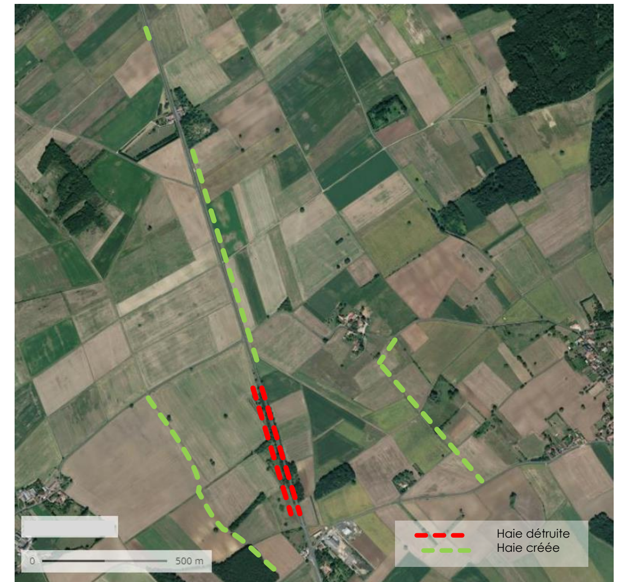
Figure 49 : Réseau de haies à l'issue des travaux de desserte
